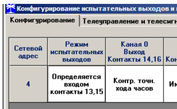
Рисунок 12 Конфигурирование испытательного выхода на формирование сигнала контроля точности хода часов
